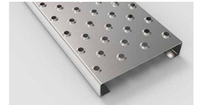
Type AP 2 - 50 sans drainage (ZAW) Type AP 3 - 50 sans drainage (ZAW) Perforation antidérapante Ø 14 mm perforée sur une hauteur de 4 mm en quinconce de 50 mm. Pas de trous de drainage.
